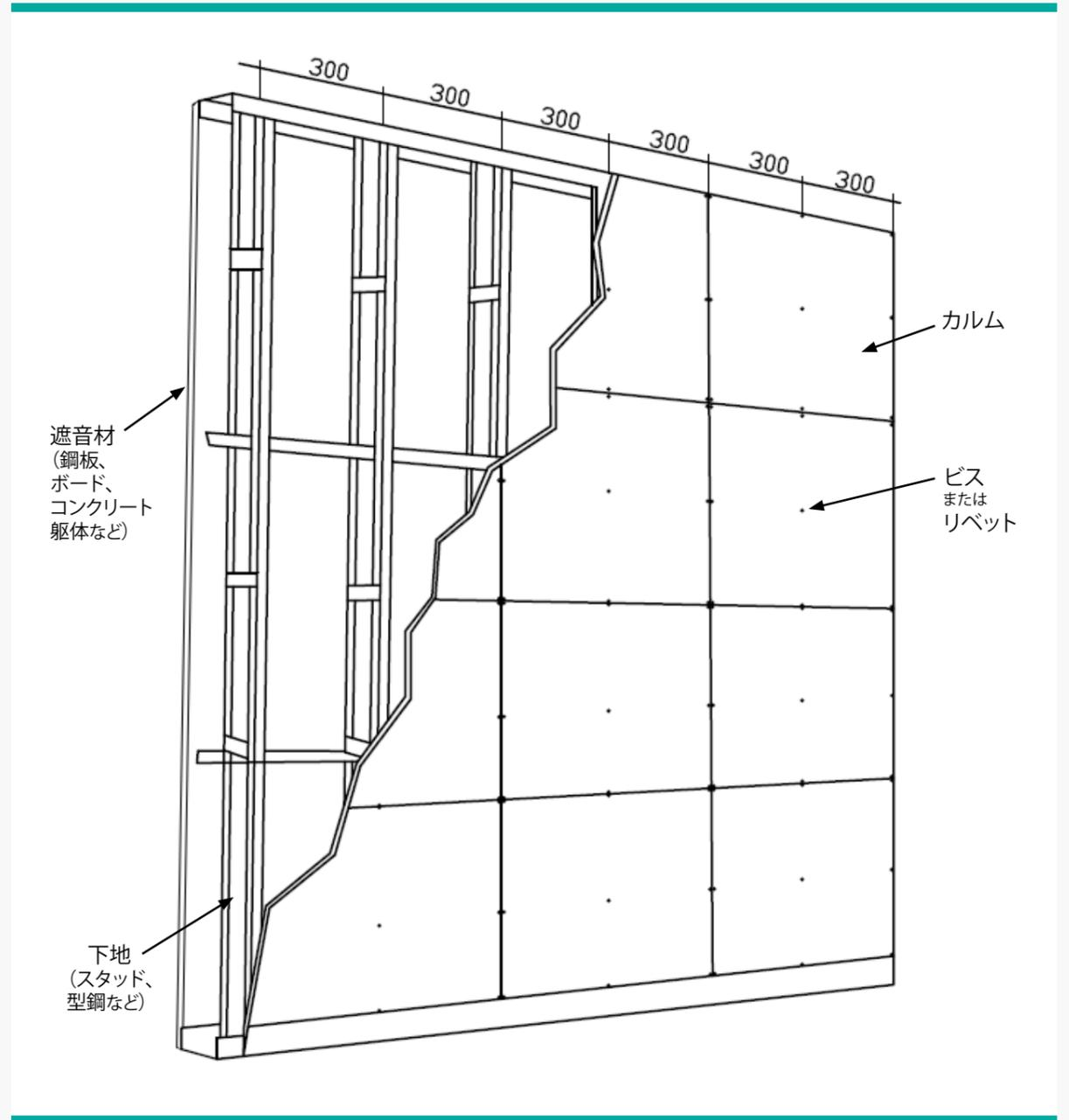
カルムの取り扱いは通常のアルミ板・鉄板と 基本的に同じです。300mmピッチ程度に下地(スタッドや型鋼)を取付け、ビスまたはリベットにて締結します。ビス穴はカルムの端面より12mm以上離し、加工してください。
