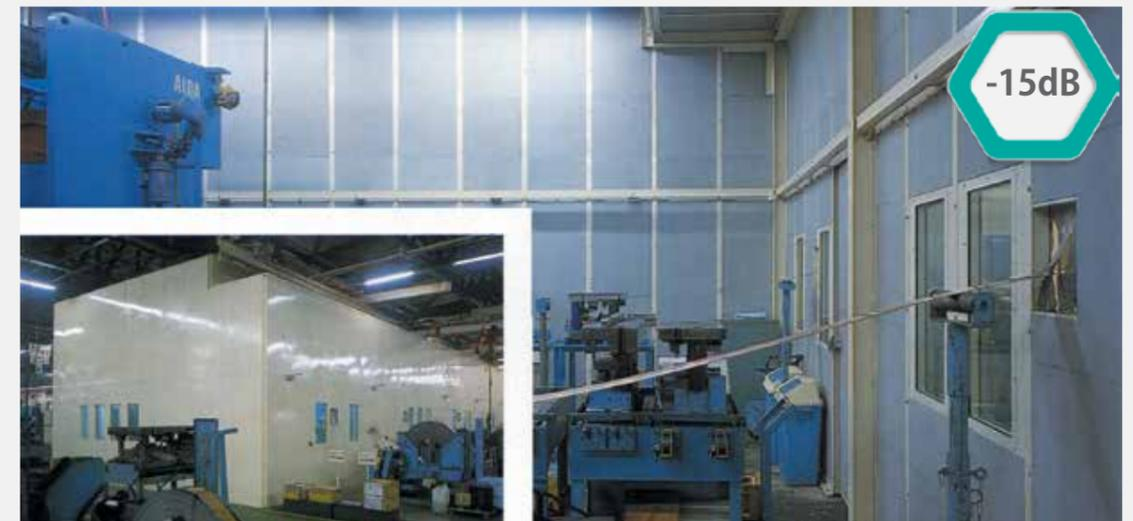
大型プレスラインの場合、プレス本体に防音壁・シャッターを取付け、入口・出口部に防音カバーを設置します。中・小型プレス機では設備全体を防音室内に納めます。中・小型プレス機が多数・集中し設置されている場合、個別に対策を行うよりも1つの防音室に納めた方が、効率良く騒音対策を行うことができ、さらに作業性・メンテナンス性も良好となります。
