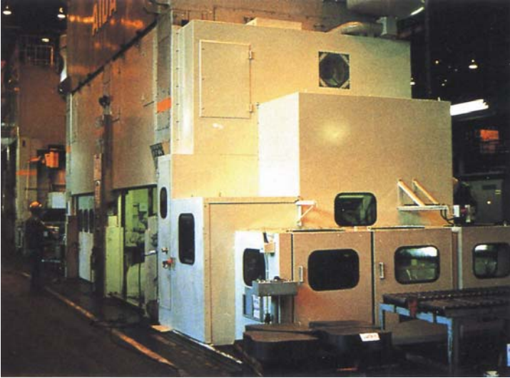
2500トン トランスファープレス（対策前 99dB→対策後 84dB）
