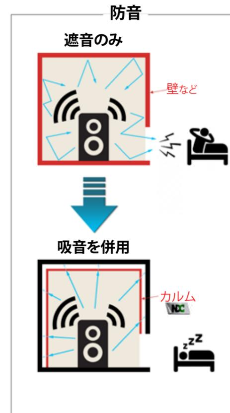
騒音源を板やコンクリートで囲う「遮音」の対策のみを行うと、遮音材で音が反響し増大します。これにより、出入口や通気口などの隙間から外に漏れる音が増幅することで遮音性能は発揮されません。遮音だけでなく、適切な吸音処理をすることによって室内の騒音が低減し、遮音材の効果も十分に得られます。
